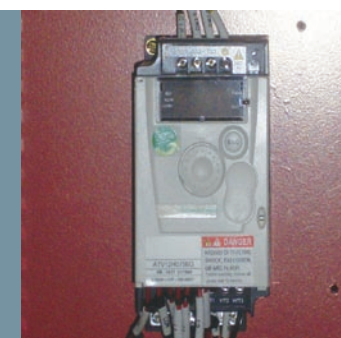
进口变频器实现平稳换向，适应多次切割，机动上丝。
