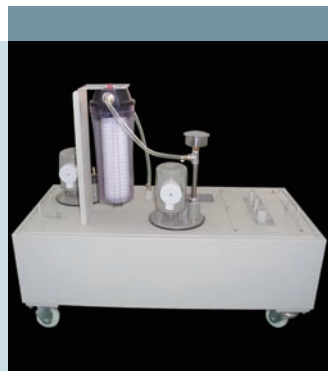
双泵水处理系统。
