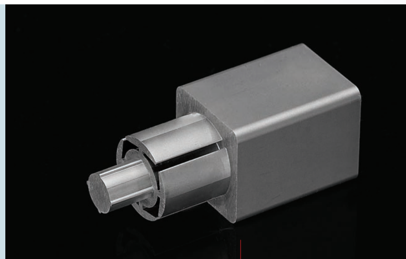
[配合件] 机型：HA500 电极材料：0.18mm/钼丝 工件材料：SKD61 表面粗糙度：0.9 μm
